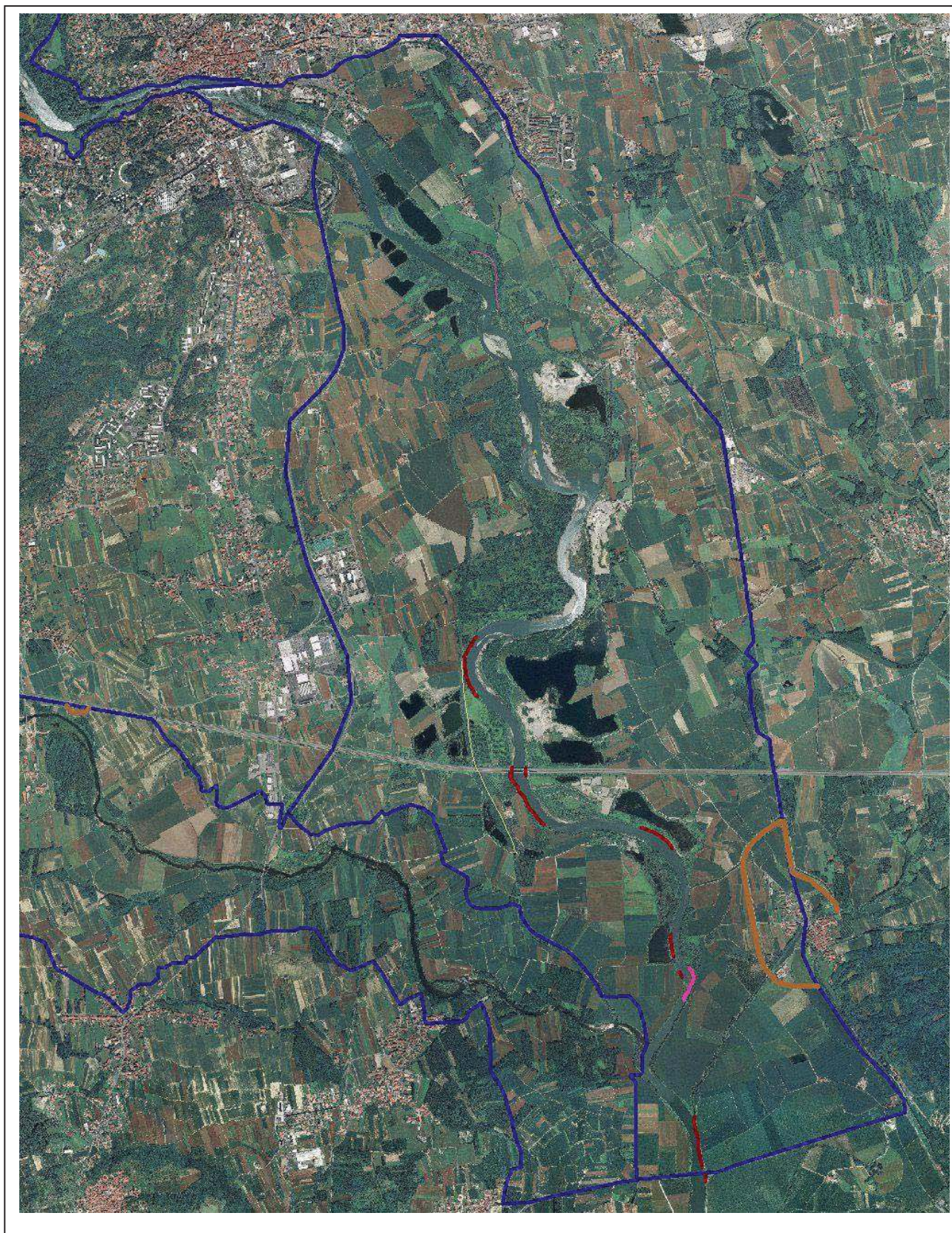
Tratto 3 con evidenziate le opere di regimazione longitudinali (scogliere in rosso e muri in rosa) e gli argini con colore arancio
