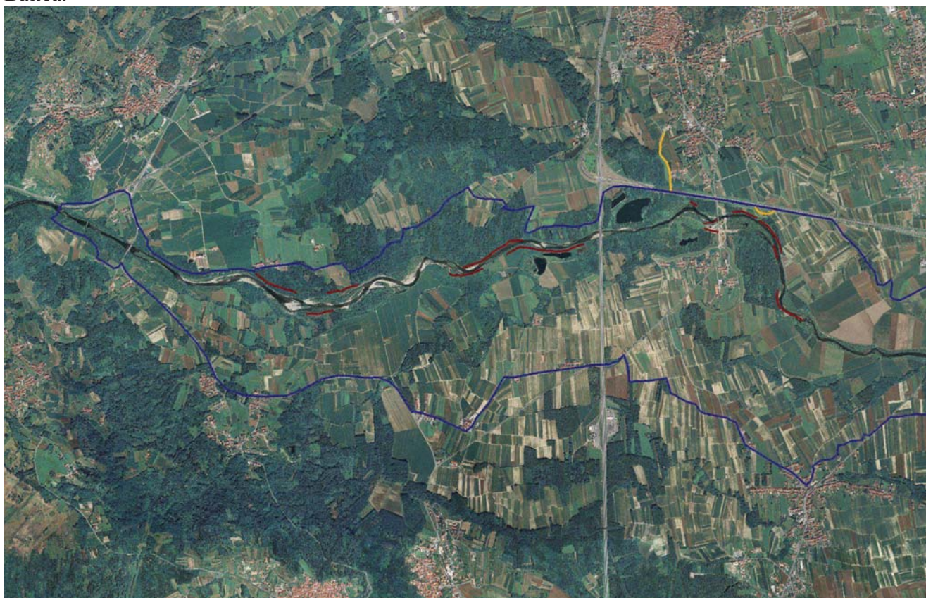
Tratto 4 del torrente Chiusella con evidenziate le opere di regimazione longitudinali (scogliere in rosso) e gli argini con colore arancio
